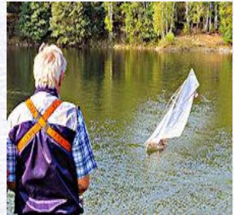
Es liegt zwar jetzt etwas unter der geplanten KWL, aber durch diese Erhöhung des Ballastgewichtes lässt sich das Modell nun gut fahren. Das Toppsegel lässt sich schnell entfernen, so dass man auch bei stärkerem Wind noch fahren kann.
