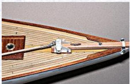
Vorn ist auf den Klüverbaum das sogenannte Nockband mit 4 Augen aufgesteckt, an ihm sind das Wasserstak, die zwei Bugwanten und das Vorstak befestigt. Sobald man die M4 Schraube mit der Radialfock entfernt, kann man den Klüverbaum einfahren und das Nockband mit Staken und Wanten abziehen.
