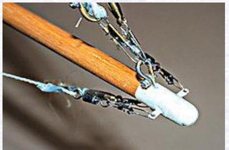
Die Saling, führt als Messing Rohr quer durch den Mast und eine Mastschelle. In das Rohr habe ich zur Versteifung einen Stahldraht geklebt, da ich das Modell an der Saling zum Einsetzen ins Wasser halte.
