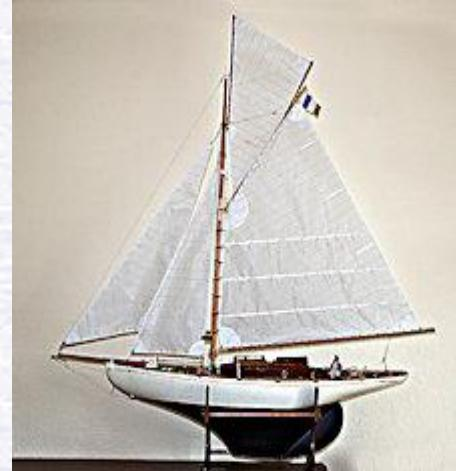
Das Modell der "Viola" ist im Maßstab 1:12 konstruiert, der Rumpf ist 106 cm lang, das fertige Modell wird ca. 127 cm lang, ca. 150 cm hoch, die Verdrängung des Modells beträgt theoretisch ca. 8,0 kg.
