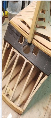
Bepankung der Gillung mit Ebenholzplanken
