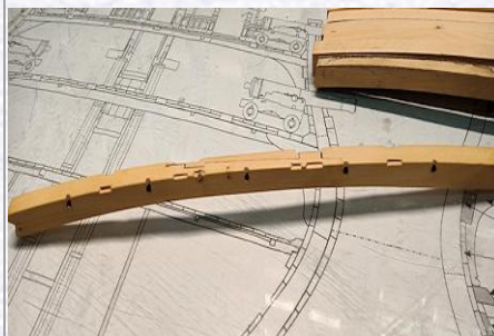
Aussparungen für die Schlingen oder Kalmai (carlings) und Schergänge (binding strakes).
