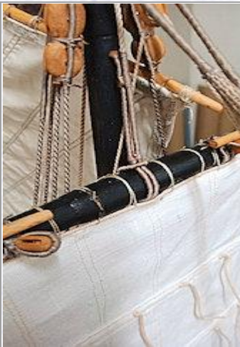
Das Drehreep der Marsrah durchläuft eine Scheibe im Topmast...
