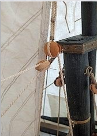
...und stroppt einen Block. Dieser Block sitzt sehr dicht über einem Block des Gaffelpieckfalls. Sein Bewegungsspielraum bestimmt den Bereich, in dem sich die Rah auf und ab bewegen kann. Das ganze will fein aufeinander abgestimmt sein.
