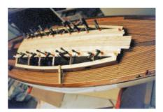
Auf diese Balken und VerstĤrkungen wird das Unterdeck befestigt. Das Unterdeck besteht aus 1-mm-Sperrholz. Dieses Deck wird hauptsĤchlich nur als TrĤger für die Decksbeplankung benötigt. Das Unterdeck wurde angepaßt und anschließend die Unterseite komplett dünn mit Epoxi eingestrichen und auf den Decksbalken verklebt. So wurde in einem Arbeitsgang das Holz gleichzeitig wasserfest, stabilisiert und miteinander verklebt.
