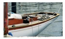
Am 28.Juni 1957 wurde die Yacht durch eine Explosion im Hafen von Lemwerder zerstĶrt und zum Sinken gebracht. Sie wurde daraufhin neu aufgebaut und der Rumpf auf 10,3 m verlĤngert. Der Kajütaufbau wurde nach vorn verlängert und eine Notausgangsluke eingebaut.
