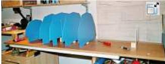
Aufstellen der 6 Spanten (5 Haupt- und ein Hilfsspant. Die Spanten werden später mit einer Säge innen ausgeschnitten).
