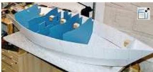
Der Rumpf ist nun vom Baubrett gelöst. Nun muss noch der Spiegel eingeklebt werden und die Planken innen mit Längsverstärkungen versteift werden.
