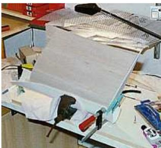
Fertigung des Kiels auf einer Positivform. Für die vordere Rundung wurde das Kunststoffmaterial ca. 20 min bei 180 Grad im Backofen erwärmt und über der Form gebogen. Nach der Erstellung des Kiels, wurde dieser im Rumpf eingepasst und verklebt. Danach habe ich die Spanten ausgeschnitten. Bilder hiervon folgen im zweiten Teil des Bauberichtes.
