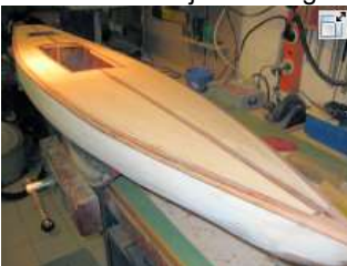
das Deck ist aufgebracht
