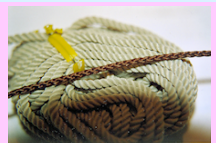
Bild 12.45: Eine geschlagene (im Hintergrund) und eine geflochtene Schnur im Vergleich. Eine geschlagene Schnur erkennt man sehr gut an ihrer Oberflächenstruktur, die an eine Spiralfeder bzw. an ein Gewinde erinnert.
