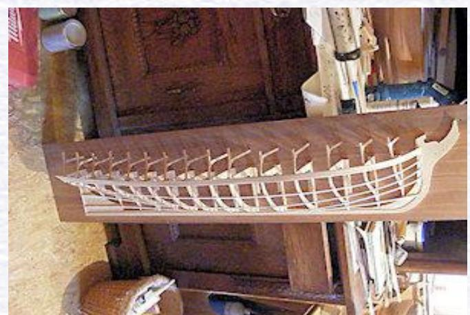
Der Weg ist ganz einfach. Man wähle einen Maßstab so groß wie möglich, möglichst im nachher zu bauenden Originalmaßstab, übertrage die Linien auf ein ca. 5 mm starkes Sperrholz, stelle die Spanten in den dafür vorgesehenen Abständen auf und lege Stracklatten darüber.
