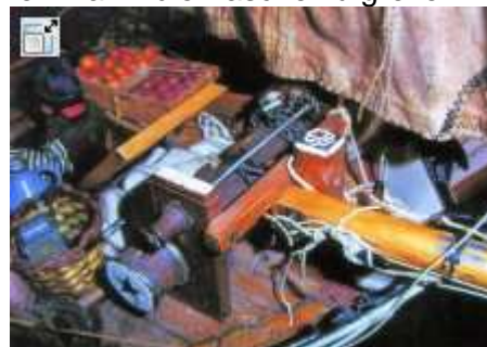
Ankerwindemitt umlegbarem Klüverbaum
