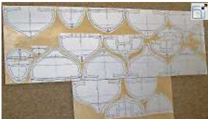
Bild 2: Spanten auf 6-mm Sperrholz
