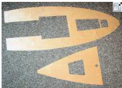
Bild 6: Unterdeck aus 1mm Sperrholz
