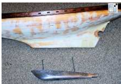
Bild 8: Rumpf mit abnehmbarem Bleikiel
