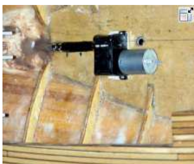
Bild 9: Motorgetriebeset Robbe Navy S 4,8V
