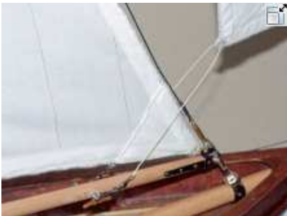
Bild 23: Befestigung der Tauschlinge am Fockbaum:
