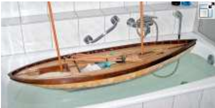
Bild 18: erste Schwimmprobe zur Kontrolle der Konstruktionswasserlinie
