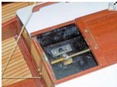
Bild 13: geöffnete Schiebeluke des hinteren Daches mit Schnellverschluss und Schalter für Empfangsanlage
