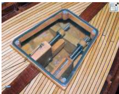
Bild 11: Verstellung der Spannung der Umlaufschoten
