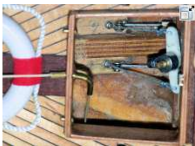
Bild 15: Öffnung für Ruderhebel und Schotführung
