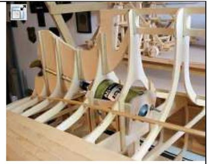
Es folgte ein sorgfältiges Verschleifen aller Spanten sowie der Kanten von Vorsteven, Kiel und Heck unter nochmaliger Verwendung von Strakleisten. Ich wollte die anschließende Beplankung so wenig wie möglich schleifen und spachteln müssen.
