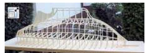
Achtersteven eingeleimt werden. Beidseitig wurden Sperrholzverstärkungen angeleimt. Der Vorsteven bekam den keilförmigen Spant 1 angeleimt, an den nach der Beplankung der nach oben rund auslaufende Bugklotz aus Abachi angepaßt wird.
