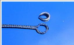
Die vorgefertige Kausche und der vorgebogene Edelstahldraht. Spätere Einbaulänge berücksichtigen!
