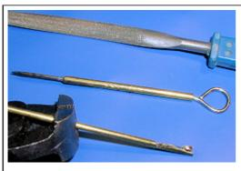
In das verwendete Messingrohr sollte der Draht bequem hineinpassen, so daß man später etwas "Fleisch" übrig hat. Zuerst wird das Rohr halbseitig abgefeilt, dabei die Enden bis auf Wandstärke herunter.
