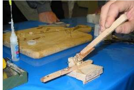
Mit einer Hebelvorrichtung wird eine Prägung auf die Wangen eingedrückt
