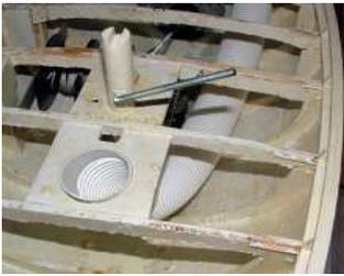
Hier das ca. 4 cm große Einzugsloch mit "Sanitärschlauch", vor dem Mast-Ansatz. Am Mastansatz ist auch die Gewindestange zu erkennen, auf die der Spinnakerbaum aufgeschraubt und wie ein Scheibenwischer vor dem Mast her nach Steuerbord bzw. Backbord bewegt wird.
