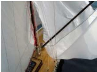
Der Spi ist draußen; Spi-Baum wird nach Steuerbord gesenkt.
