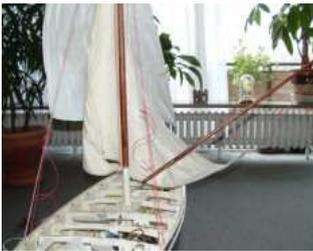
Zum Shiften wird der Spi-Baum wie ein Scheibenwischer gedreht, gleichzeitig lockert sich das Seil, das das eine Schothorn am Baum-Ende festhält (ist wichtig zum Bergen). Wenn der Baum senkrecht steht, wird die Genua auf die andere Seite (hier also nach Steuerbord) rübergezogen.
