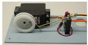
Um dies zu verhindern ist ein Schalter eingebaut der den Windenmotor beim Fieren nur dann laufen läßt wenn genug Zug auf der Schot ist.
